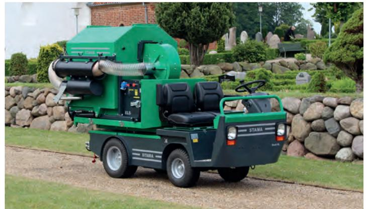
**STAMA Multi EL 48 V 4 KW AC-Motor + Aufbau-Saugereinheit**
